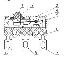
1 按鈕 Plunger 2 密封圈 Hermetic loop 3 蓋 Cover 4可動片 Moving piece 5電觸點 Contact 6底座 Case 7常閉端子 NC terminal 8 常開端子 NO terminal
